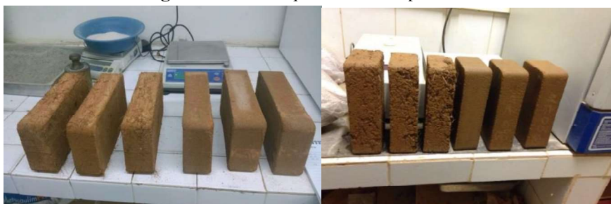
Figura 8. Blocos após abrasão superficial.
